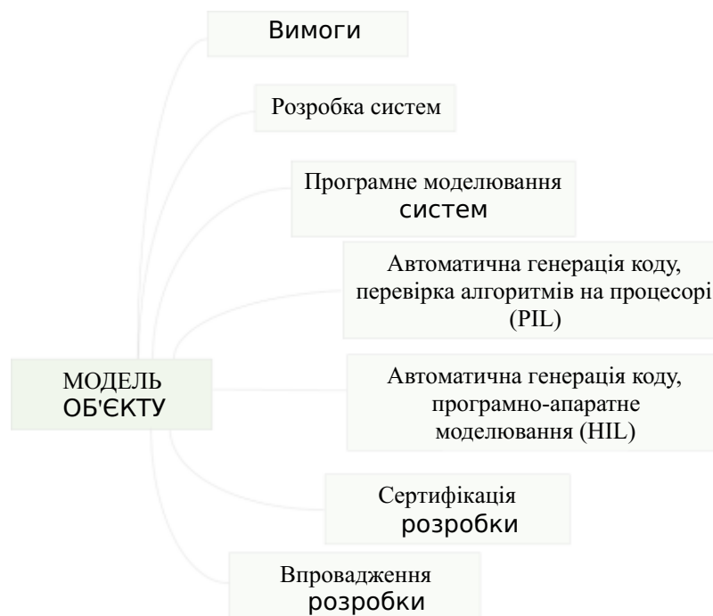
Рис.2.1. Етапи модельно - орієнтованого проєктування
